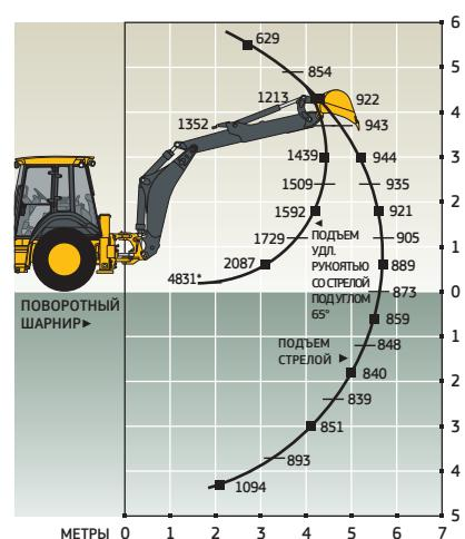
\*Грузоподъемность указывается только для устойчивого положения. Значения грузоподъемности приведены для крайней точки стрелы на машине с опущенными аутригерами и шинами, касающимися грунта.
