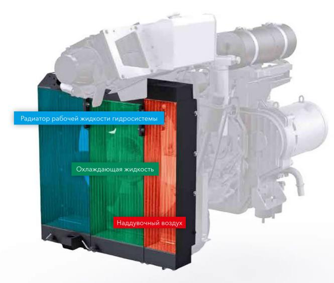
Многосекционный радиатор большого размера разделен на три зоны. За счет этого поддерживается оптимальная температура наддувочного воздуха, охлаждающей жидкости двигателя и рабочей жидкости гидросистемы.
