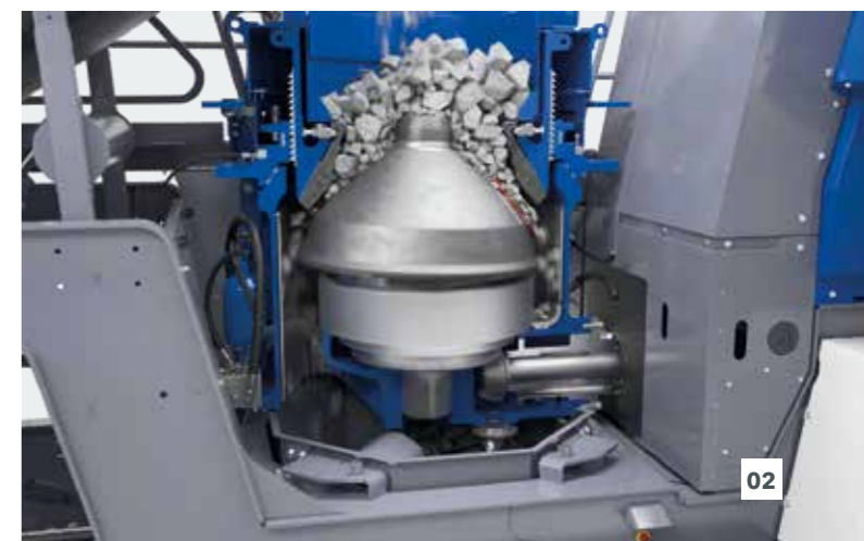
01 Пропускная способность дробилки 02 Регулировка ширины выходной щели
