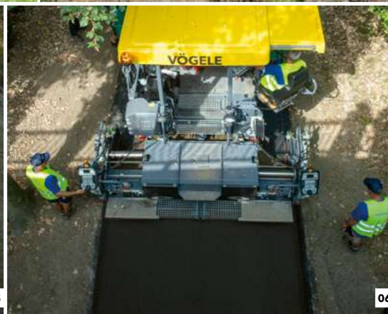
04 Конструкция платформы обеспечивает отличный обзор. 05 Оптимальная загрузка благодаря вместительному приёмному бункеру. 06 Благодаря раздвижному рабочему органу AV 340 TV достигается высокая степень предварительного уплотнения.
