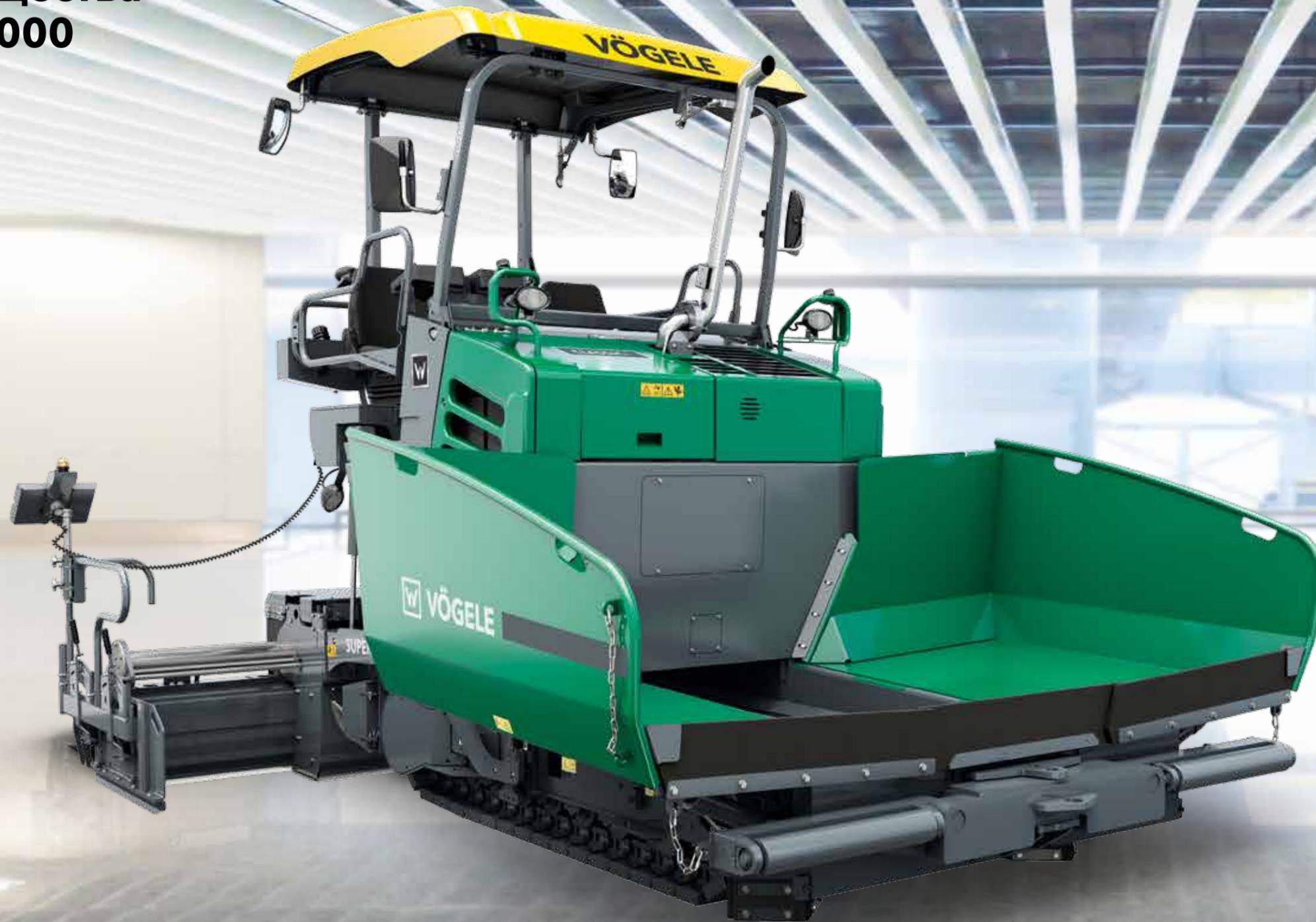
**Гусеничный асфальтоукладчик класса Compact Class** с широким спектром областей применения при ширине укладки до 3,9 м
