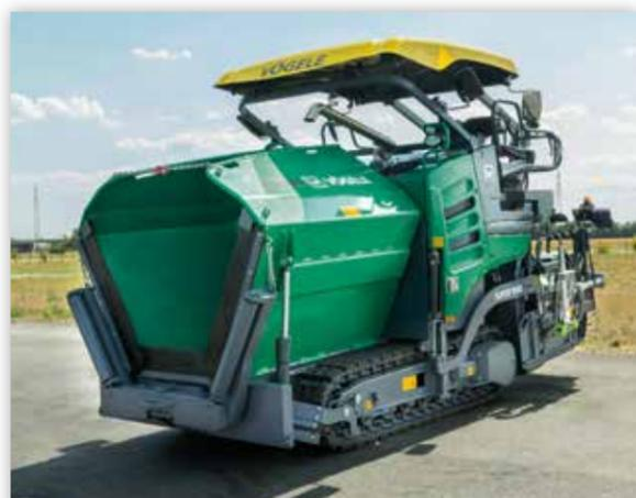
» **Компактная конструкция** без выступающих краёв и небольшая общая длина значительно упрощают работу и маневрирование на маленьких стройплощадках.
