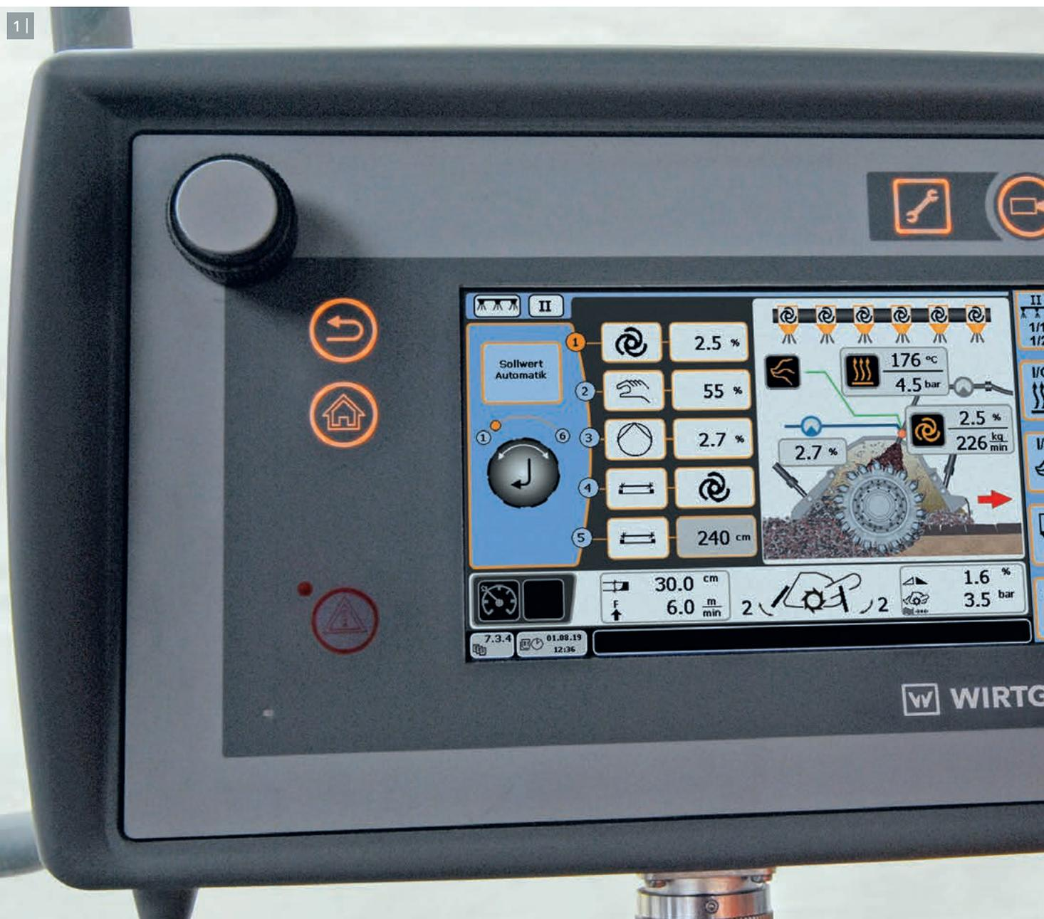
1 | **Наглядность:** важные параметры машины постоянно отображаются в нижней строке в меню дозирования.
