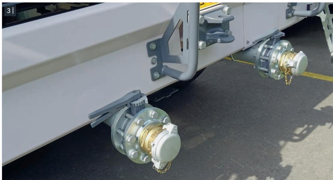
3 | Разъёмы для подачи воды и эмульсии хорошо доступны.
