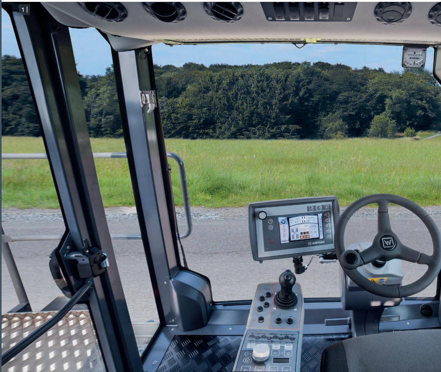
Доступ ко всем важным функциям машины возможен с помощью многофункционального джойстика на правой консоли-подлокотнике. Расположение кнопок подчиняется логическому принципу, позволяя легко управлять функциями. Сиденье водителя, включая подлокотники и рулевую колонку, поворачивается на 90°. Это позволяет машинисту наблюдать за процессами в задней зоне машины в расслабленной позе.
