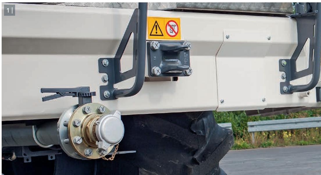
1 | Все шланговые соединения установлены в передней части машины.
