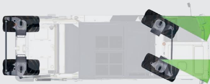
Задние колёса при этом автоматически остаются в нейтральном положении. Ими можно управлять отдельно с помощью джойстика.
