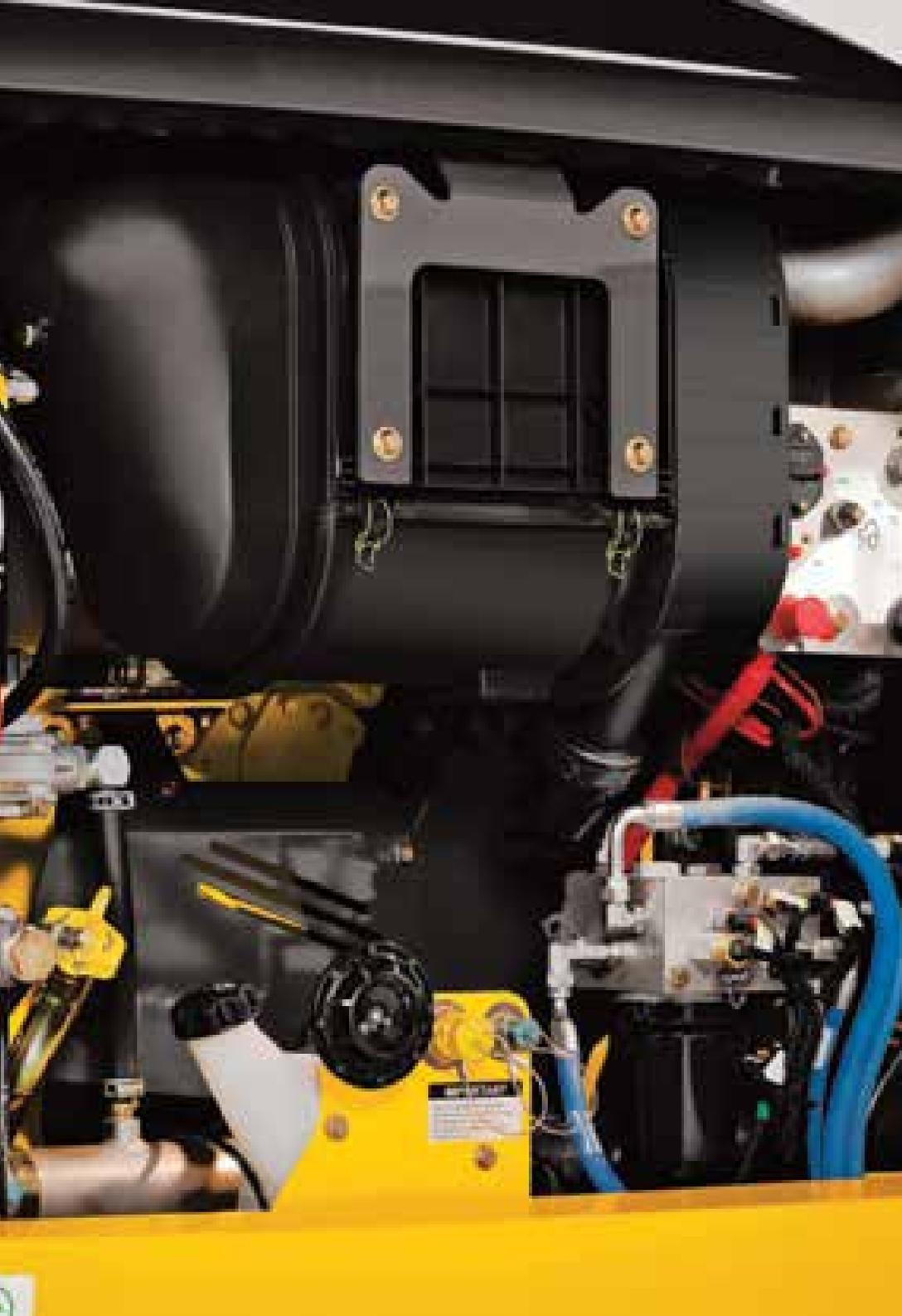
1. Навесные поворотные-откидные вентиляторы и радиаторы обеспечивают широкий доступ к сердцевинам, благодаря чему их очистка выполняется просто и быстро.
