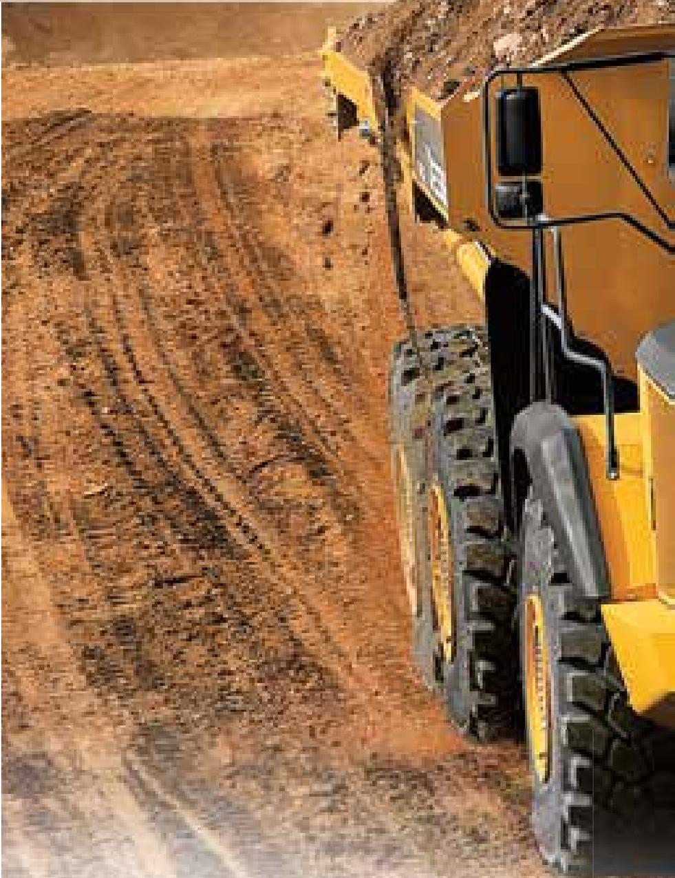
**1.** Задняя подвеска с четырьмя тягами, предназначенная для тяжелых условий работы, обеспечивает максимальное сцепление шин с грунтом, поддерживая оптимальное тяговое усилие и устойчивость при движении по неровной местности и изрытой колеями дороге. Широкопрофильные шины, представляющие собой одну из многочисленных опций, обеспечивают превосходную проходимость на мягком грунте.
