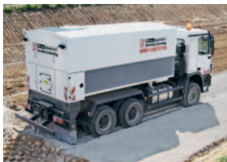
▲ SW 16 TC: Стабилизация грунта цементом для устройства промышленной зоны
