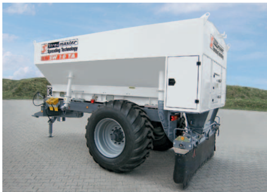
▲ Распределитель ТА на одноосном прицепе, с бункером 10 м 3
