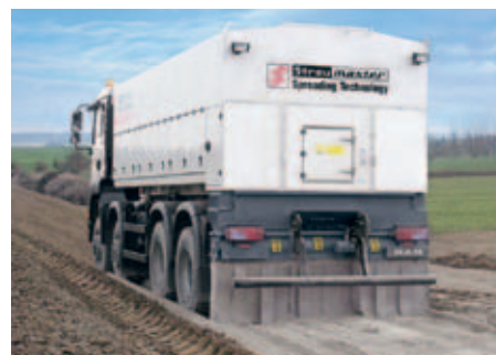
▲ SW 16 TC: Стабилизация грунта цементом для устройства промышленной зоны
