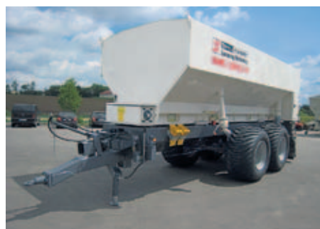
▲ Распределитель ТА на двухосном прицепе, с бункером 16,5 м 3
